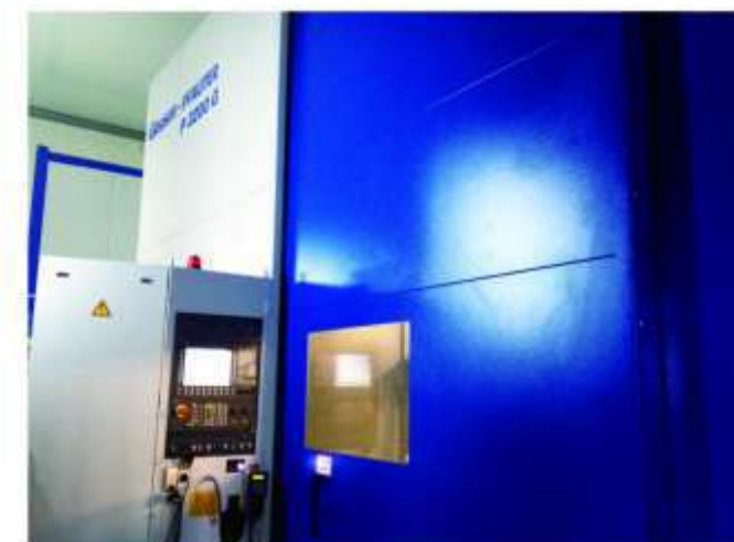
数控齿轮加工中心 P-3200 Gleason-Pfauter hobbing machine P1600/2000
