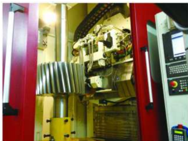
德国纳尔司公司5米数控成形磨齿机 Germany NILESO 5m CNC grinding machine
